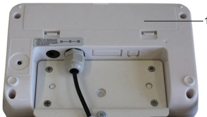
Aprire il coperchio del vano accumulatore (1) nel basso del display e collegare l'accumulatore. Prima del primo uso l'accumulatore dev'essere caricato per almeno 12 ore.
