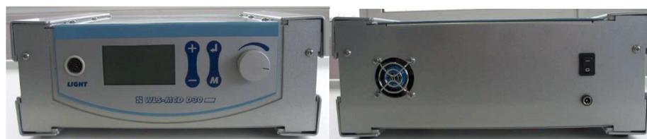
Controllare che l'interruttore (I/O), posto sul retro, sia in posizione O, inserire il connettore dell'alimentatore sul pannello posteriore (24V DC) e di seguito collegare l'alimentatore alla rete (220V~). Dopo aver inserito il connettore del manipolo Led nel pannello anteriore nella presa L1, portare l'interruttore I/O in posizione I e controllare che il Display posto sul pannello anteriore sia acceso e che la ventola presente nel manipolo Led sia in funzione.
