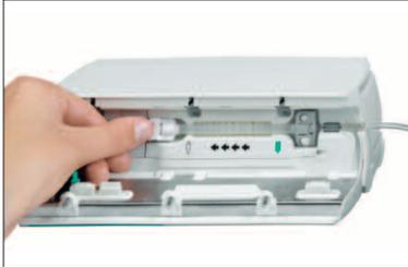
Fissare la clip bianca. Assicurarsi che il segmento in silicone non sia stirato o attorcigliato e che le stelline disegnate sul tubo siano allineate e non ruotate.
