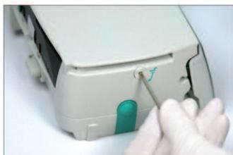
Ruotare la chiave a brugola per rimuovere il tappo di apertura di emergenza.
