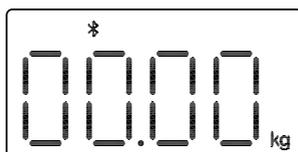
Se l'abbinamento non viene eseguito, il simbolo "✱" non verrà visualizzato sul display LED.
