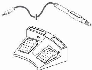
**Un manipolo senza pulsanti (opzionale) e pedale doppio (opzionale):** collegare il manipolo sulla boccola indicata ACTIVE e premere il pedale giallo per selezionare ed erogare la corrente di taglio (la scelta tra CUT e BLEND deve essere effettuata premendo il tasto corrispondente sull'apparato) o il pedale blu per selezionare ed erogare la corrente di coagulazione (la scelta tra FORCED COAG, SOFT COAG e BIPOLAR deve essere effettuata premendo il tasto corrispondente sull'apparato).
