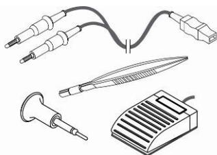
**Una pinza bipolare (opzionale) e pedale singolo:** Collegare l'adattatore opzionale (REF 00498.04) (vedi pag. 22). L'apparecchiatura si dispone sulla sola funzione BIPOLAR. Erogare la corrente premendo il pedale. Per non danneggiare la pinza non cortocircuitarne le punte.
