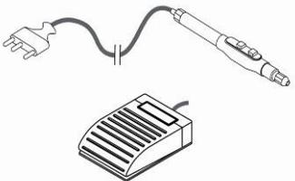
**Un manipolo con due pulsanti e il pedale singolo:** impostare tramite i tasti di selezione sull'apparato tra taglio CUT o BLEND e coagulazione FORCED COAG, SOFT COAG o BIPOLAR, preselezionare, tramite tasto giallo del manipolo, la funzione di taglio selezionata sull'apparato o preselezionare, tramite tasto blu del manipolo, la funzione di coagulazione selezionata sull'apparato. L'emissione avviene tramite pedale.
