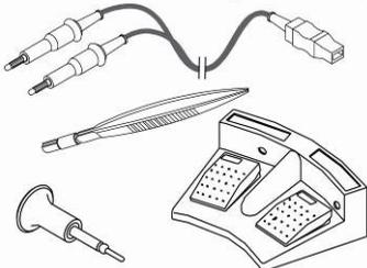
**Una pinza bipolare (opzionale) e pedale doppio (opzionale):** Collegare l'adattatore opzionale (REF 00498.04) (vedi pag. 22). L'apparecchiatura si dispone sulla sola funzione BIPOLAR. Erogare la corrente premendo il pedale associato alla coagulazione (blu). Per non danneggiare la pinza non cortocircuitarne le punte.
