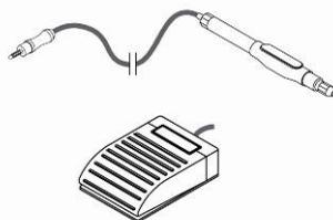
**Un manipolo senza pulsanti (opzionale) e pedale singolo:** collegare il manipolo sulla boccola indicata ACTIVE e selezionare la corrente di taglio CUT o BLEND o la corrente di coagulazione FORCED COAG, SOFT COAG o BIPOLAR e per erogare la corrente desiderata premere il pedale.
