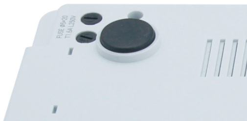
Figura 9-1 Sostituzione del fusibile
