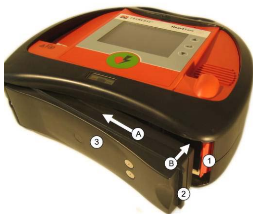
Fig. 10: Inserimento del modulo di alimentazione
