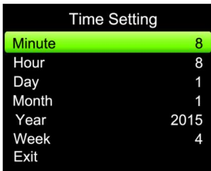
Figure 21 Interface de paramétrage de l'heure
