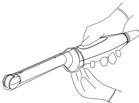
4. Inspectez le couvre-sonde afin de vérifier qu'il n'y a pas de trou ou de déchirure.
