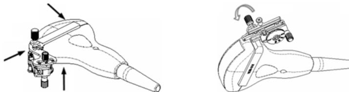
3. Vissez la noix de serrage du guide-aiguille afin de fixer ce dernier sur la sonde.
