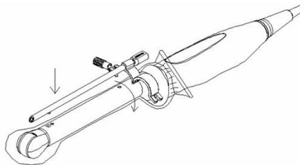
3. Quand la bride de retenue est correctement placée, utilisez l'écrou de blocage pour la maintenir en position. Le guide-aiguille est alors correctement monté.
