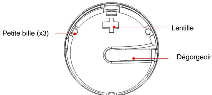
Si du liquide est vaporisé sur la boule de commande, la majeure partie de ce liquide s'évacue par le dégorgeoir. Vous pouvez terminer de sécher le dispositif à l'aide du chiffon.
