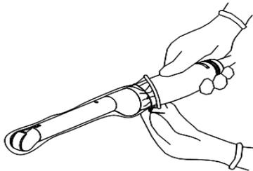
2. Ouvrez la bride de retenue, alignez le guide-aiguille avec la sonde de manière à ce que le bourrelet de positionnement du guide-aiguille soit face aux rainures de positionnement de la sonde, puis tournez la bride de retenue afin de maintenir cette position.
