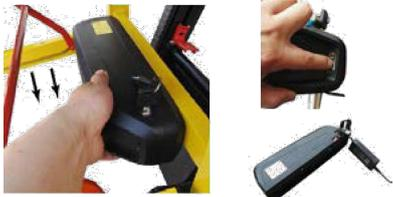
**Démontage :** ouvrir la clé, tenir la batterie et la tirer latéralement. Vérifier l'alimentation : maintenir le symbole d'alimentation de la batterie enfoncé.
