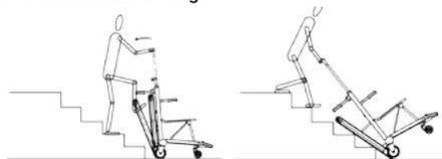
1. Ouvrir le cadre du rail et régler la position de la barre. Tirer le levier avec les deux mains, placer le pied droit sur le cadre du rail au-dessus du tube transversal et redescendre la chaise.
