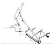
5. Pendant la descente, placer les mains légèrement vers le bas de la barre d'accouplement pour ne pas provoquer de chocs. Lors d'un arrêt à mi-chemin, desserrer la clé.
