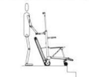
1. Pousser le fauteuil d'escalade au sol jusqu'à ce que les roues avant soient posées sur le bord de l'escalier.
