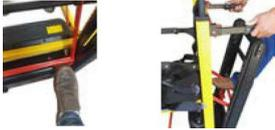
Ouverture : Monter sur la pédale ; le châssis s'ouvre alors automatiquement grâce à son système de levage à gaz.
