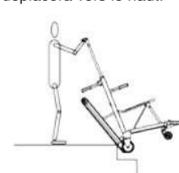
3. S'il est nécessaire de s'arrêter à mi-chemin, relâcher le bouton de l'étage. En montant, il n'est pas nécessaire de tirer la chaise avec les mains vers le haut. Elle doit être dans un angle vertical le long des escaliers. Il suffit juste de maintenir la chaise et d'appliquer une petite pression.
