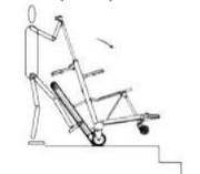
4. À l'arrivée à la dernière marche, tirer la barre d'accouplement avec les deux mains, puis remonter lentement et soulever la chaise jusqu'au sol. L'opération ne nécessite pas de gros efforts car il n'est pas nécessaire de monter les escaliers.
