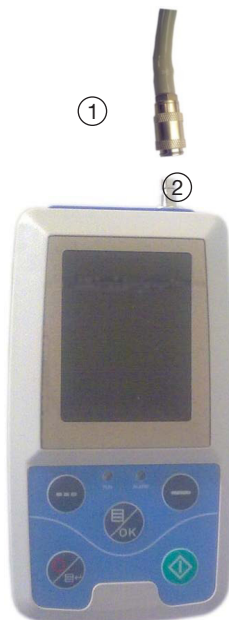
Figura 1 Presa aria superiore
