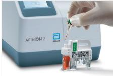
Inserire la cartuccia nell'analizzatore e chiudere il coperchio. L'analisi si avvia automaticamente.
