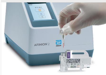
**3** Inserire la cartuccia nell'analizzatore e chiudere il coperchio. L'analisi si avvia automaticamente.
