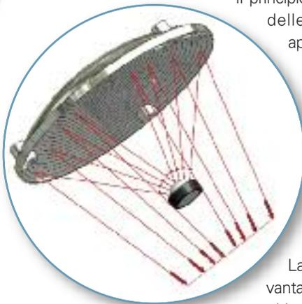
Il principio fisico della riflessione è alla base delle lampade Rimsa e trova applicazione tramite un sistema di ellissi. Esse riflettono infatti i raggi luminosi emessi dai Leds sull'area da illuminare, ottenendo così un'elevata intensità luminosa con un ridotto numero di Leds: oltre 50.000 lux ad 1 metro di distanza con soli 12 Leds.
