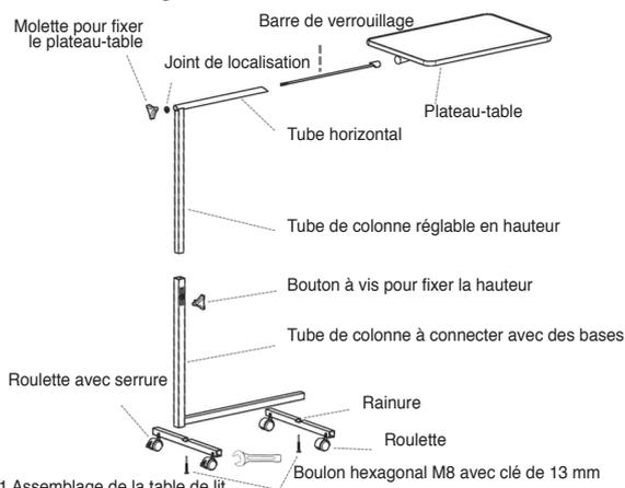
FIGURE 1 Assemblage de la table de lit
