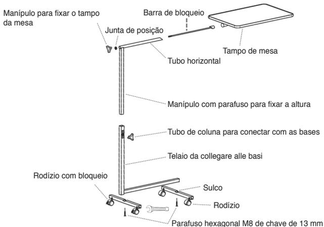
FIGURA 1 Montagem da Mesa auxiliar de cama
