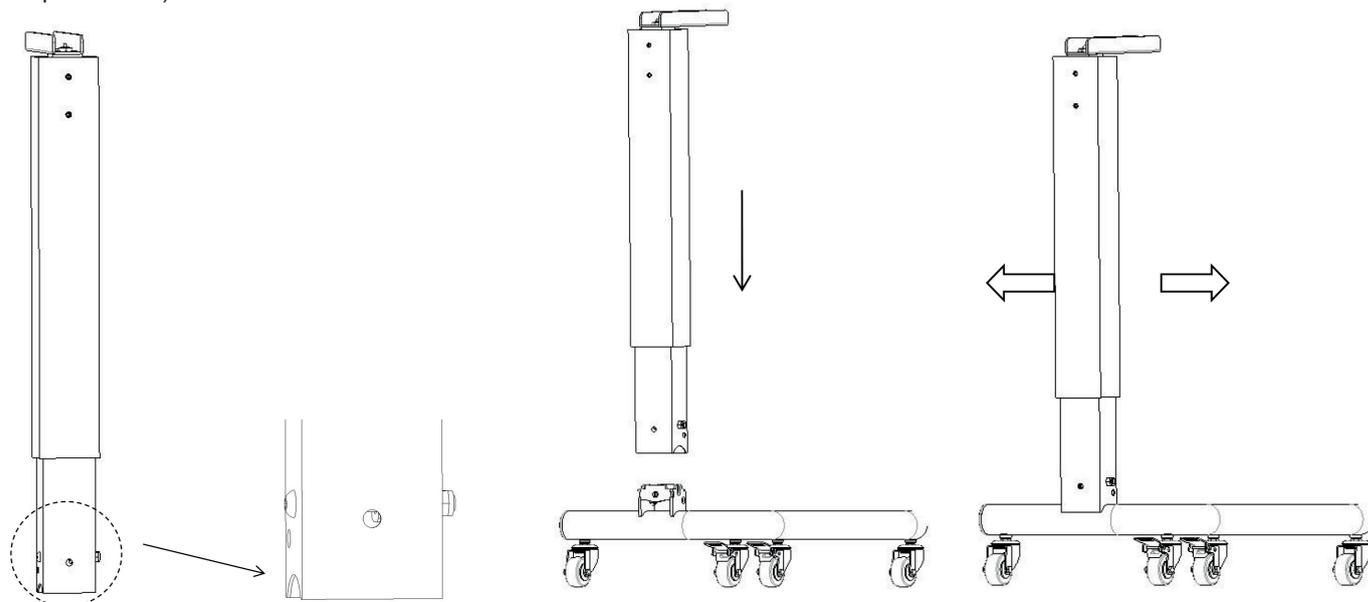
Extrayez de l'emballage la vis à six pans creux de l'élément rond M8\*25, la rondelle plate  $\varphi 8$  et la rondelle élastique  $\varphi 8$  ; posez tout d'abord les vis des deux côtés du rehausseur, puis celles d'un côté du rehausseur.
