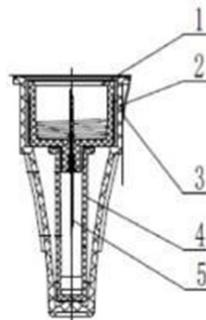
Figura 1. Aguja estéril para pluma de inyección de insulina de un solo uso
