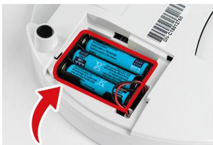
5. Insérez d'abord le logement de la pile alcaline, puis disposez soigneusement le câble dans le logement en bas
