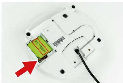
5. Inserte la batería con la escritura hacia arriba y el cable conector hacia la izquierda. Primero inserte la batería y luego coloque cuidadosamente el cable en el hueco en la parte inferior
