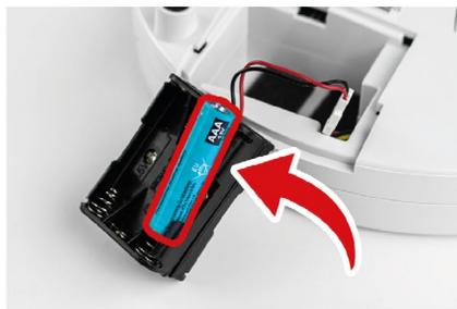
4. Inserte las nuevas pilas alcalinas
