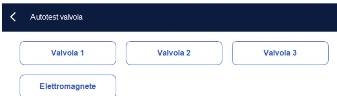
3. Haga clic en el número de válvula deseado (por ejemplo, 1) y, a continuación, compruebe si funciona correctamente mediante el sonido de su apertura y cierre.
