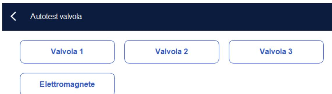
3. Cliquez sur le numéro de vanne souhaité (par exemple 1), puis vérifiez s'il fonctionne correctement par le bruit de son ouverture et de sa fermeture.
