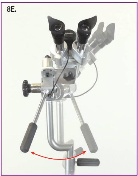
8E. Tire la manija de ajuste fino de altura hacia atrás y hacia la derecha, o empújela hacia adelante y hacia la izquierda.
