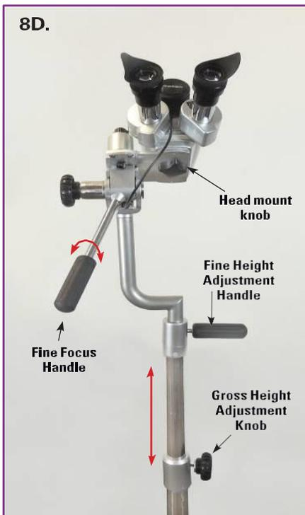
8D. Gire la perilla de ajuste fino de altura para mover el cabezal ligeramente hacia arriba o hacia abajo. Utilice la perilla de ajuste de altura total para ajustar la altura a mayor altura.
