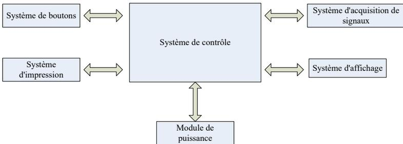
Figure 4-2 Schéma fonctionnel de l'unité de contrôle
