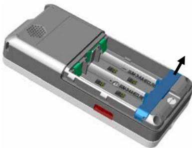
2. Insérez la batterie lithium-ion dans le compartiment, en alignant le signe + de la batterie sur celui indiqué dans le compartiment.
