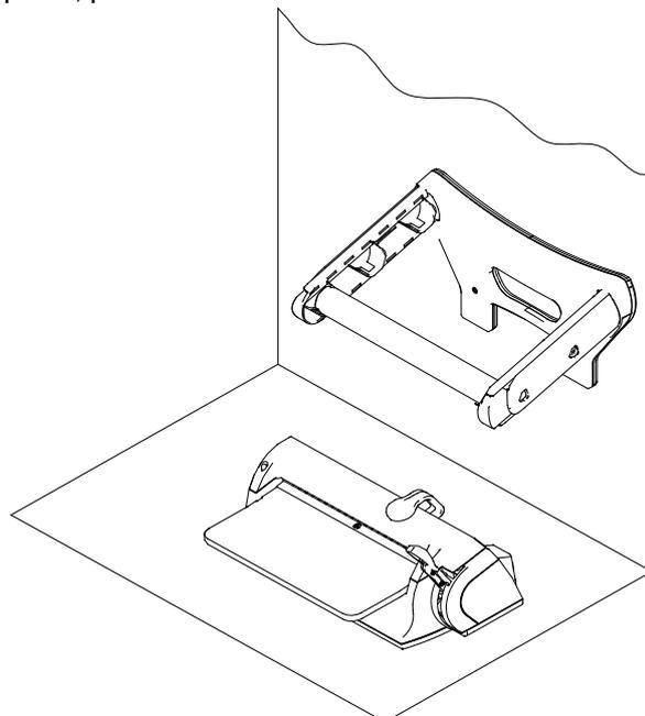
Lorsque le porte-rouleau est fixé au mur, la station de scellement et de découpe occupe 325 mm à cause des glissières en acier.
