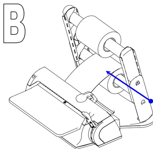
4) Tirez le rouleau jusqu'à la longueur souhaitée et abaissez la poignée de scellement. La led clignote en vert pendant la phase de scellement (pendant 3 secondes).
