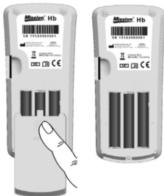
Cierre la cubierta de las baterías y asegúrese que suene al cerrarse. Verifique nuevamente y regrese al programa del reloj tantas veces como sea necesario después de reemplazar las baterías para asegurarse que el tiempo está correctamente programado. Consulte con la Sección 4 Programación Inicial.
