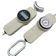
dinamometro idraulico push-pull
