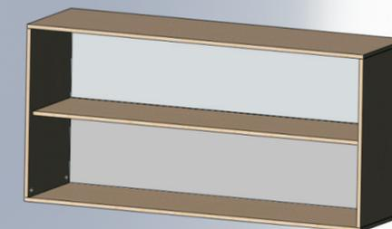
5 inserire il fianco dx e fissarlo mediante i 4 barilotti
