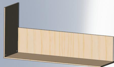
2 inserire i barilotti di serraggio e girare in senso orario, posizionare lo schienale nel canale
