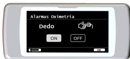
La imagen de la derecha es un ejemplo del encendido-apagado de la alarma advirtiendo sobre el dedo no insertado en el sensor de oximetría.
