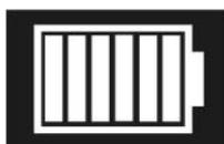
Esta imagen indica que el pack de baterías está completamente cargado (6 indicadores). La disminución en la carga del pack de baterías se muestra mediante una reducción de los indicadores.
