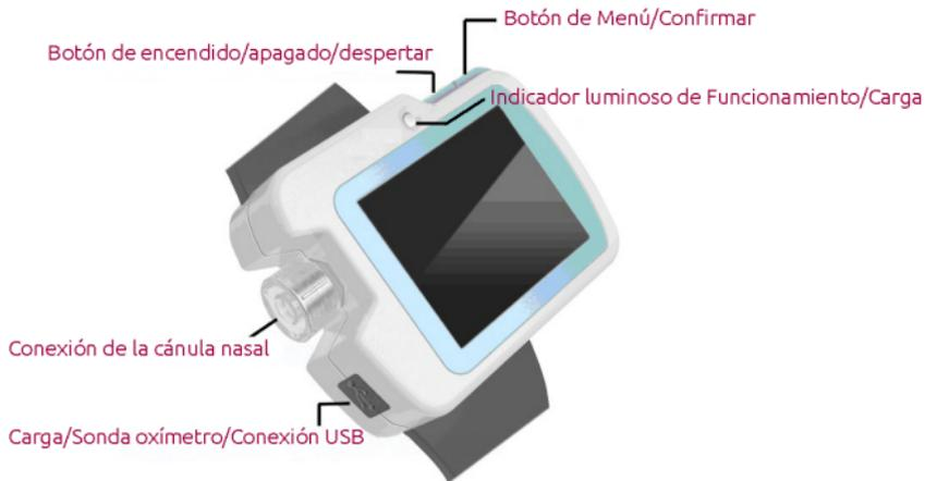
El dispositivo está compuesto por una unidad principal, una cánula de oxígeno nasal, una sonda SpO<sub>2</sub>, un adaptador de corriente (opcional), una línea de datos USB y software PC. La unidad principal no tiene piezas desmontables, las piezas aplicables: la cánula de oxígeno nasal y la sonda SpO<sub>2</sub> son piezas desmontables.
