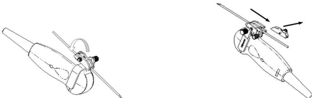
(2) Separe la parte residual del soporte guía para aguja y el transductor de la aguja.
