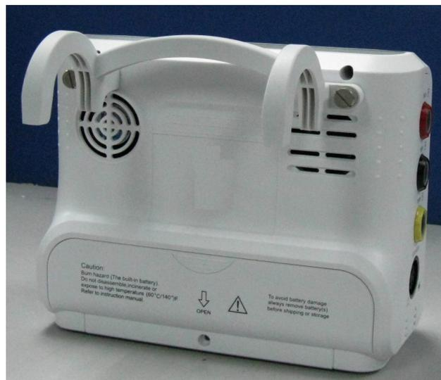
**Figura 3.9 Installazione della maniglia**
