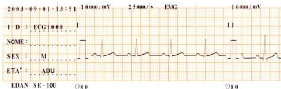
Come illustrato dalla figura, la registrazione ECG include: data e ora, numero ID, nome (scritto successivamente dal medico), sesso, età, sensibilità, velocità di stampa, parametri del filtro, nome derivazione, impulso di calibrazione 1mV, ECG, battito cardiaco, produttore e modello dell'apparecchio
