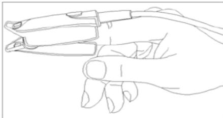
Image 2.6 Mise en place du capteur SpO<sub>2</sub>
