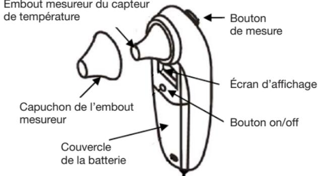
Image 2.7A capteur de température infrarouge
