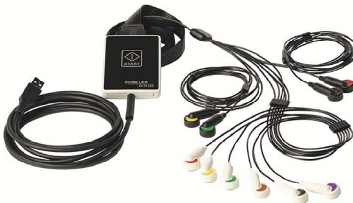
Il **MS-12 USB registratore ECG** comunica con il programma tramite un cavo USB collegato direttamente al PC. MS-12 USB non è dotato di schermo monitor ma di un indicatore del pulsante di avvio per inizializzare un ECG in modalità acquisizione e inoltre indicare il collegamento e la comunicazione con il programma CS-104..
