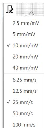
L'ampiezza e la velocità del tracciato ECG vengono regolate con l'icona in alto a sinistra della schermata.
