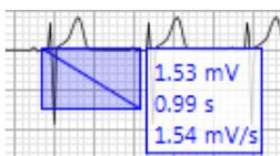
Fare clic nel punto in cui si desidera iniziare la misurazione e trascinare il mouse per visualizzare le misurazioni in relazione al punto di inizio. La misurazione rimane visualizzata finché non si esegue una nuova selezione con il mouse ed è possibile effettuare una nuova misurazione. Le misurazioni calcolate sono le seguenti:
