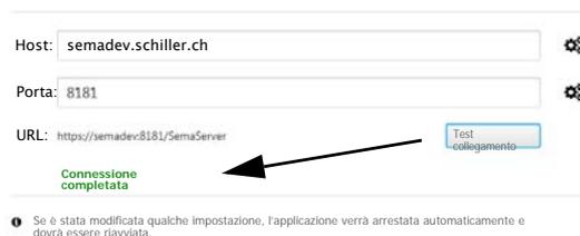
Quando si fa clic sul pulsante **Prova collegamento al server**, il programma effettua il ping del server per verificare la connessione. Una volta stabilita la connessione, viene visualizzato un messaggio di conferma. Una panoramica del Server SCHILLER è riportata nella guida alla comunicazione del server SCHILLER.
